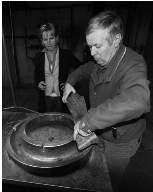
Oben: Die Formen für Schläuche sind aus vollem Metallguss
